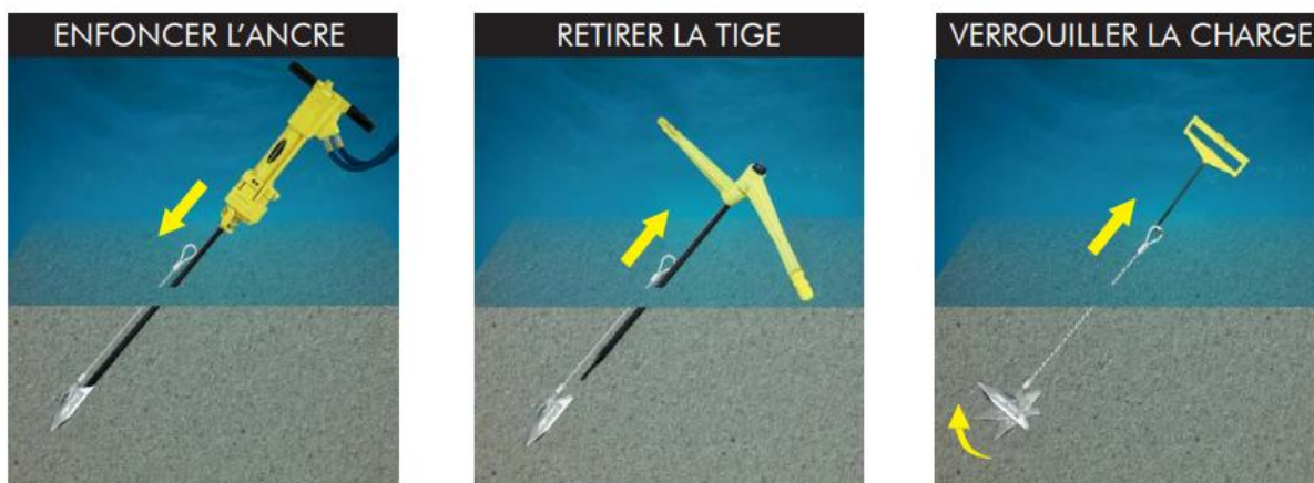
Figure 15: Étapes d'installation des ancres mantas
