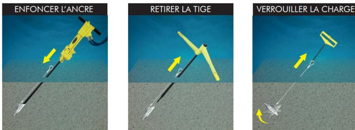
Figure 17: Étapes d'installation des ancres « manta »
