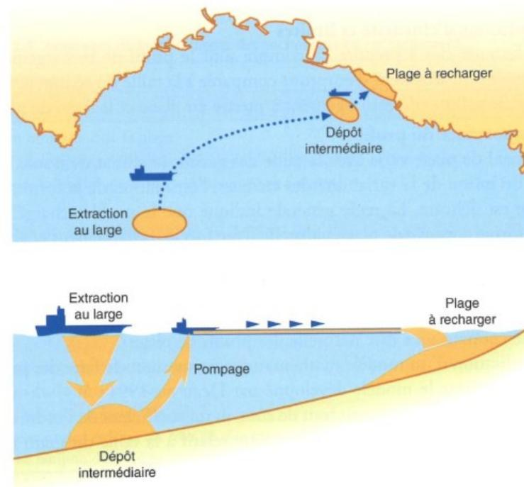
Figure 96 : exemple type de mise en œuvre de technique de rechargement de plage (source Cetmef)
