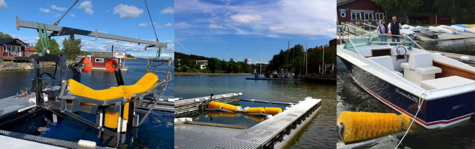
Système de lavage des carènes à flot
